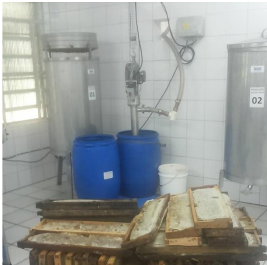
Figura 4 – Decantador e bomba de sucção Fonte: Koch, Juliana
