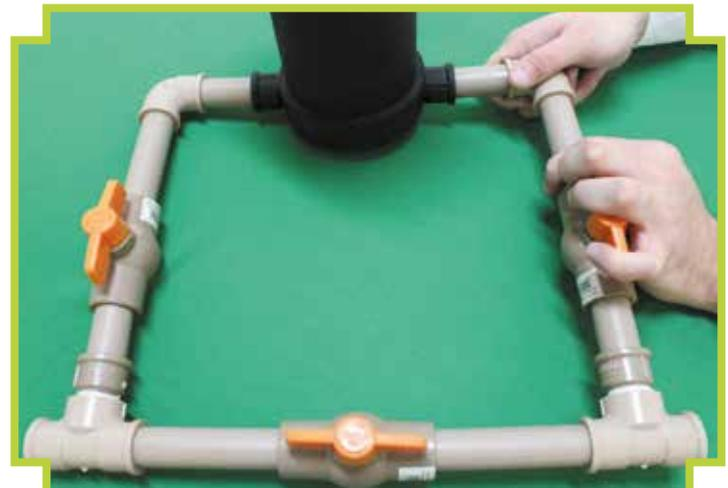
8 - Encaixe a rede lateral esquerda na rede do depósito de pastilhas de cloro
