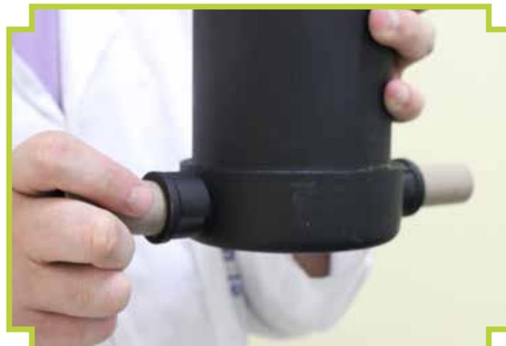
4 - Encaixe a peça de 5 cm na outra ponta do depósito de pastilhas de cloro
