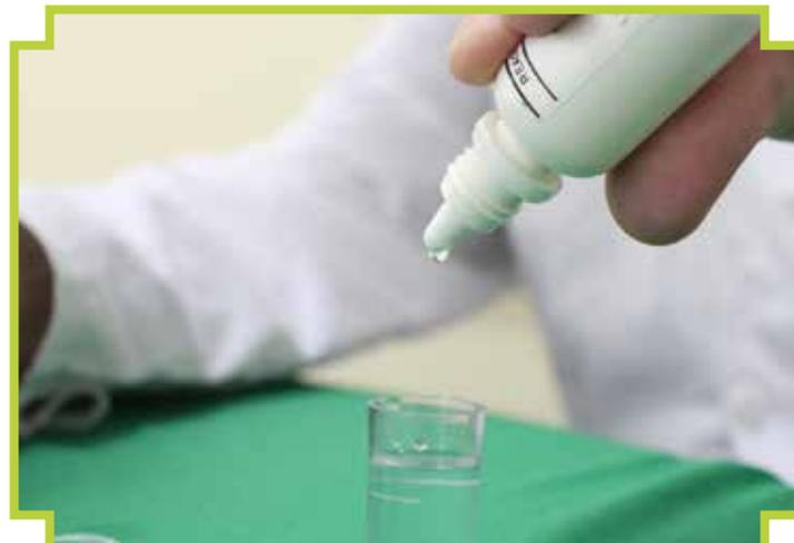
2 - Pingue 5 gotas do reagente de cloro 1 na água coletada
