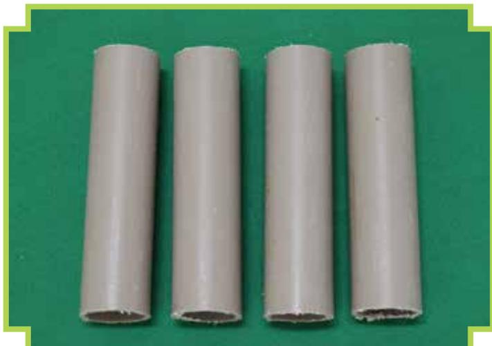
1 - Corte quatro peças de 10 cm de comprimento
