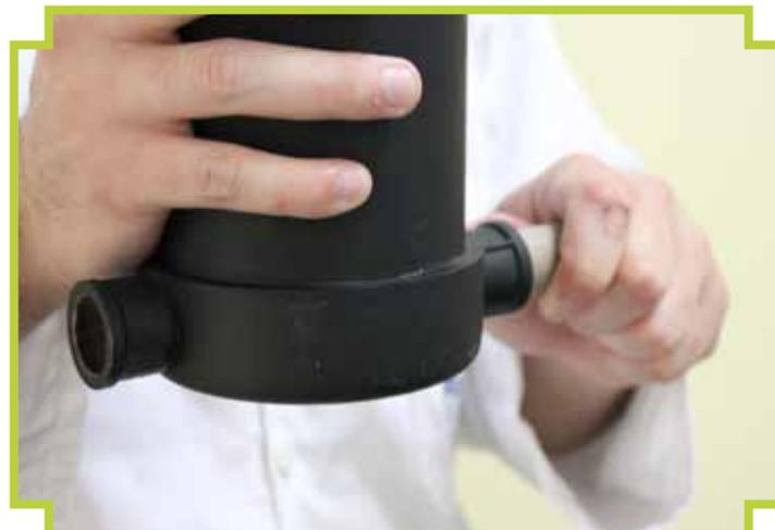
2 - Encaixe a peça de 5 cm no depósito de pastilhas de cloro
